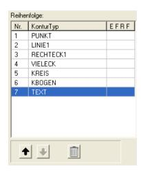
Im Reihenfolge-Feld wird die Kontur-Nummer und der KonturTyp angezeigt. Die Reihenfolge kann über die Tasten 'nach oben' 'nach unten' festgelegt werden. Eine Kontur kann mit dem Symbol 'Papierkorb' gelöscht werden.
